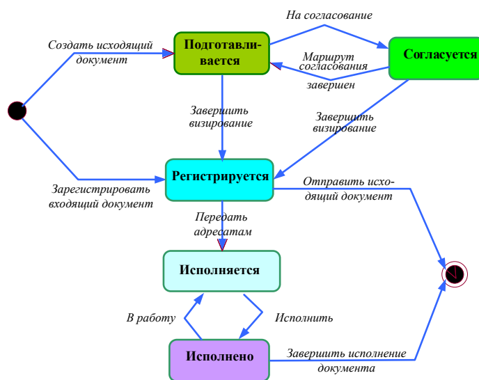
Рис. 7.4. Модель переходов фазовых состояний класса Документ
